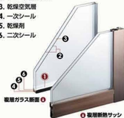
圧倒的なシェアを堅持するTWOIN(アルミニウムスペーサ)は、サッシと複層ガラスの間に装着するハイテクノロジー製品です。春夏秋冬の目眩なく快適な住環境を。TWOINは、複層ガラスの「経済性」「断熱性」「遮音性」「防露性」を強力に支えています。
